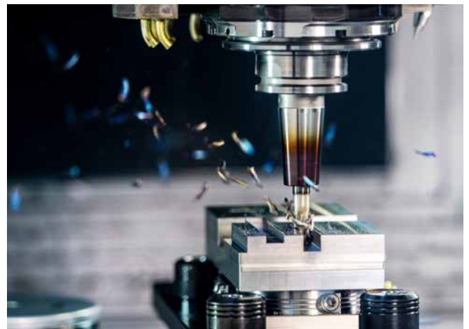
CELSIO焼きバメツールホルダーを使用したフルスロット加工
