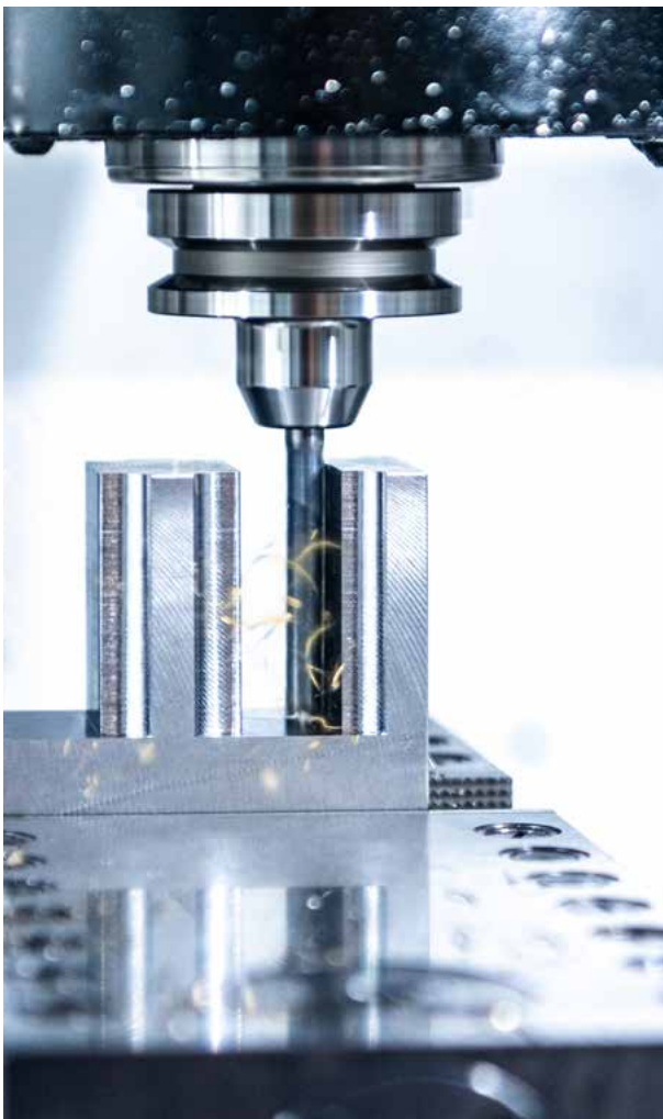
WELDONエンドミルホルダーによるフルスロット加工
