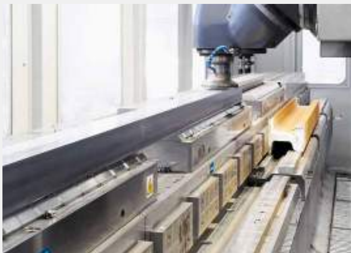
溝加工の前に、軌道エレメントをフェースミルカッターで加工します。 ワークはレールヘッドのフットとサイドでクランプされます。
