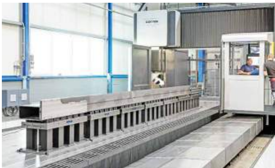
MAGNOS MFRS マグネットチャックを使用すれば長い溶接ワークを最小限の歪みでクランプできます。これにより完璧な加工品質が保証されます。
