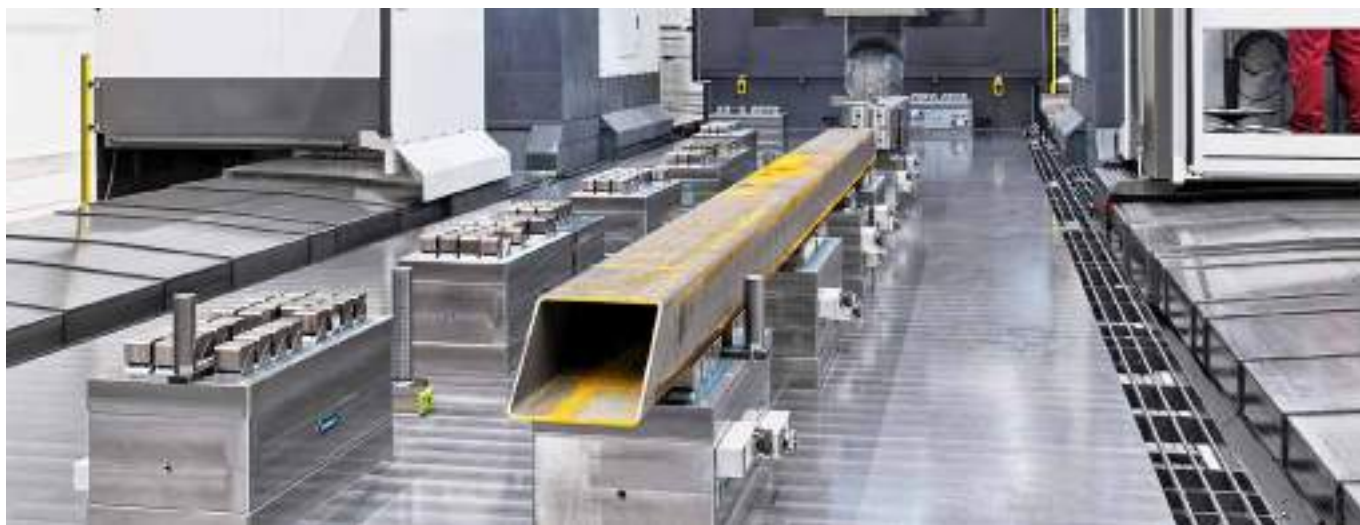
SCHUNKのマグネットソリューションにより、最大 12,000 mm の大判溶接構造物を Correa OX M ガントリー型フライス盤で加工することができます。画像：SCHUNK
