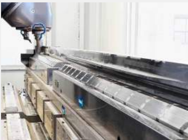
熱による歪みを補正するため、正方形のプロファイルを脚部と横方向の両方でマグネットによってクランプします。ラグを完全に加工するには、3回のセットアップで十分です。
