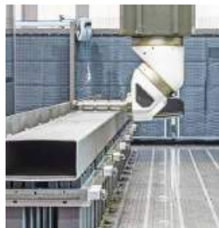
MAGNOS MFRS マグネットチャックを使用すれば長い溶接ワークを最小限の歪みでクランプできます。これにより完璧な加工品質が保証されます。
