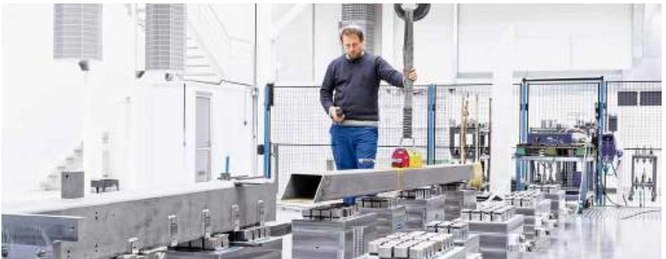
機械テーブルには溝や穴がないため、清掃が非常に簡単です。クランピングモジュールの位置が決まったら、パイプと溶接フレームをクレーンでMAGNOS クランピングモジュールに載せてクランプします。画像：SCHUNK
