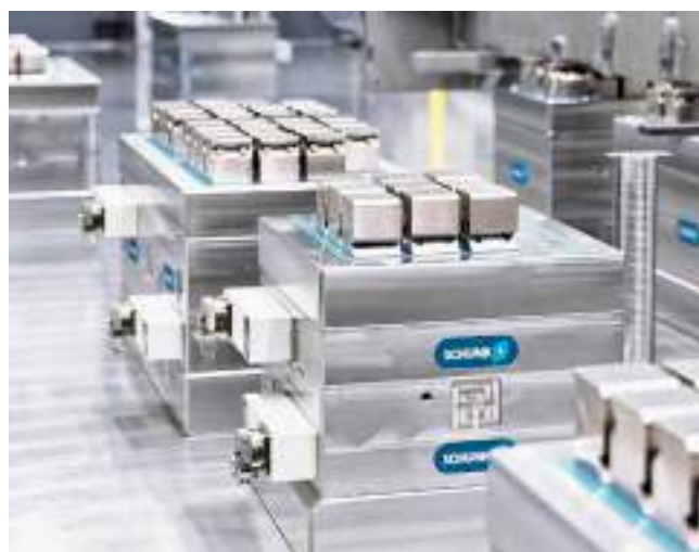
機械テーブルは鋼板で完全に覆われ、表面フライス加工が施されています。この鏡面仕上げの表面上でも、クランピングモジュールは非常に簡単に位置決めができます。ダブルマグネットの理想的な距離は、一連のテストで試されました。画像：SCHUNK
