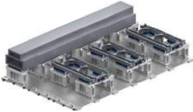
アプリケーション2 マグネットクランピングによる さまざまな中型溶接フレームの マルチクランプ
