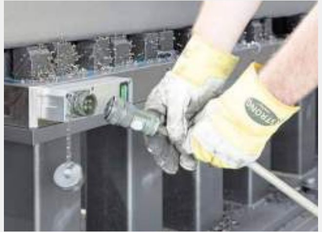
特許取得のステータス表示：「緑」は磁化状態を表示。 これでワークはこのマグネットクランプモジュールにしっかりとクランプされます。画像：SCHUNK
