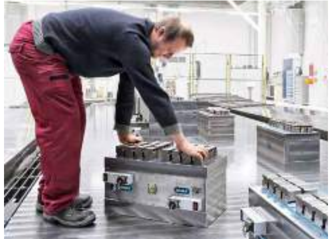
ボトムマグネットチャックが無効になるとすぐに、オペレータはクランピングブロックを手で簡単に動かすことができます。画像：SCHUNK
