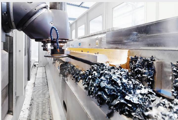
溝削り加工では、最大35ミリメートルの材料が1回の切り込みで1,750ニュートンメートルのトルクで除去されます。
