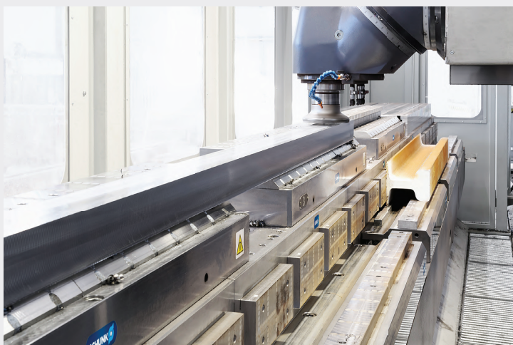
溝削り加工の前に、レール材を正面フライスで加工します。ワークは、レールヘッドの足部と側面でクランプします。
