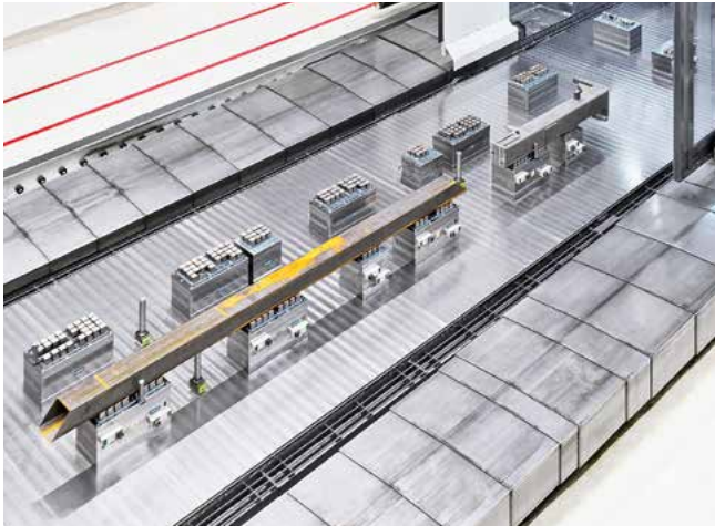
ガントリータイプのフライス盤のマシンテーブルは12,500 mm x 3,000 mm。 仕切り壁によりシャトル加工が可能。 画像：SCHUNK
