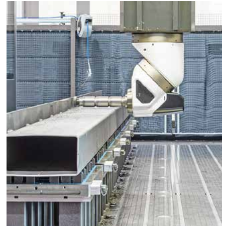
MAGNOS MFRS マグネットチャックを使用すれば、長い溶接ワークを最小限の歪みでクランプできます。これにより完璧な加工品質が保証されます。
