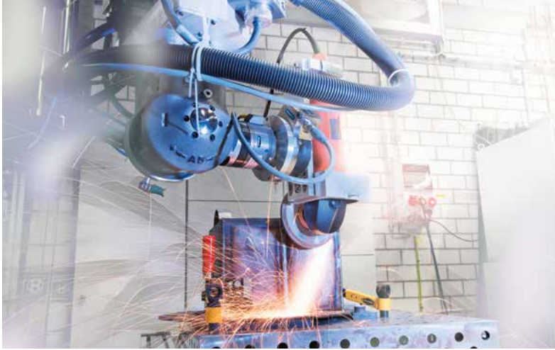
ストーブ用給気室の自動研磨
