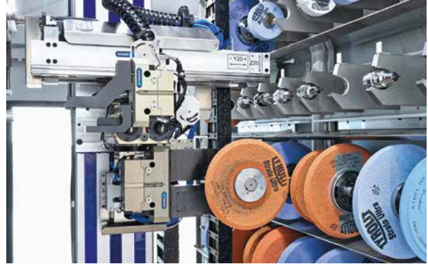
研削砥石の自動交換
